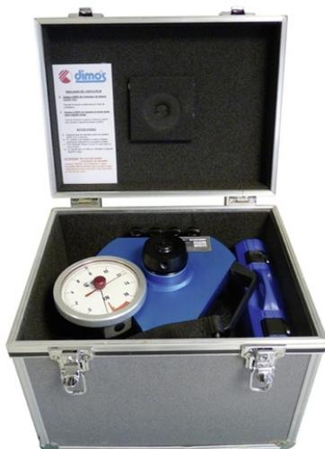
L'extractomètre est un outil de contrôle pour vérifier la résistance en traction des chevilles.
